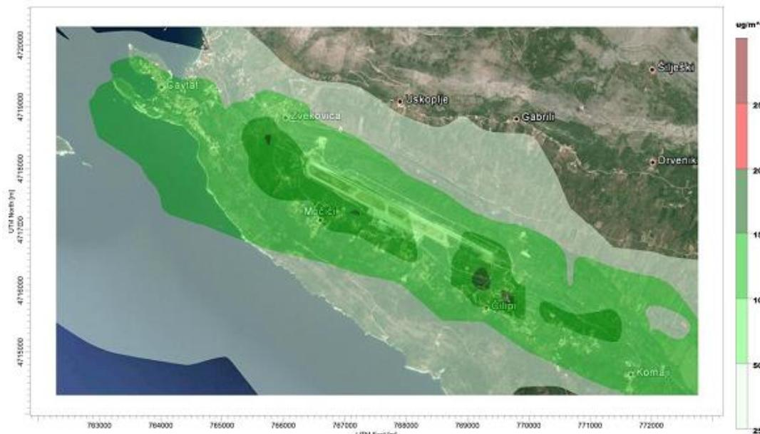
Slika 2-5. Imisijske koncentracije NOx nastale istovremenim radom glavnih motora zrakoplova (2 LTO ciklusa/sat), 10 pomoćnih agregata zrakoplova i prolaskom vozila (2400 vozila/sat) za vrijeme usrednjavanja od 1 sat. (Izvor: Studija o utjecaju na okoliš razvoja Zračne Luke Dubrovnik, Općina Konavle, Dvokut Ecro, 2014).
